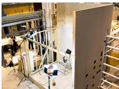
Säker Vatten-väggen under provning vid SP Sveriges Tekniska Forskningsinstitut.
